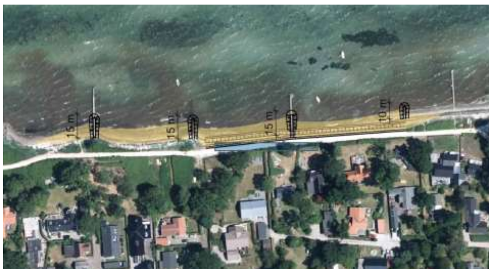
Figur 5-1 Plan over løsningsforslag med høfder, skråningsbeskyttelse og sandfodring. Se bilag 2 (tegning C3_001).
