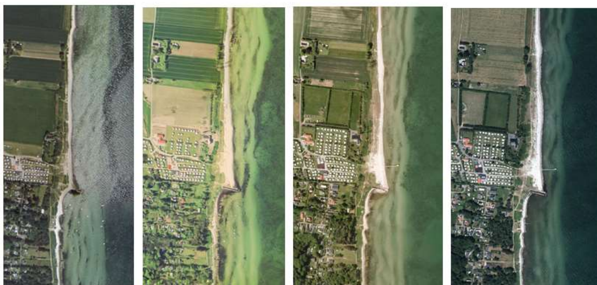
Figur 3-5 Tilsanding ved Spøttrup Strand efter anlæg af høfde i 1986. (Kilde: Miljøportalen).
