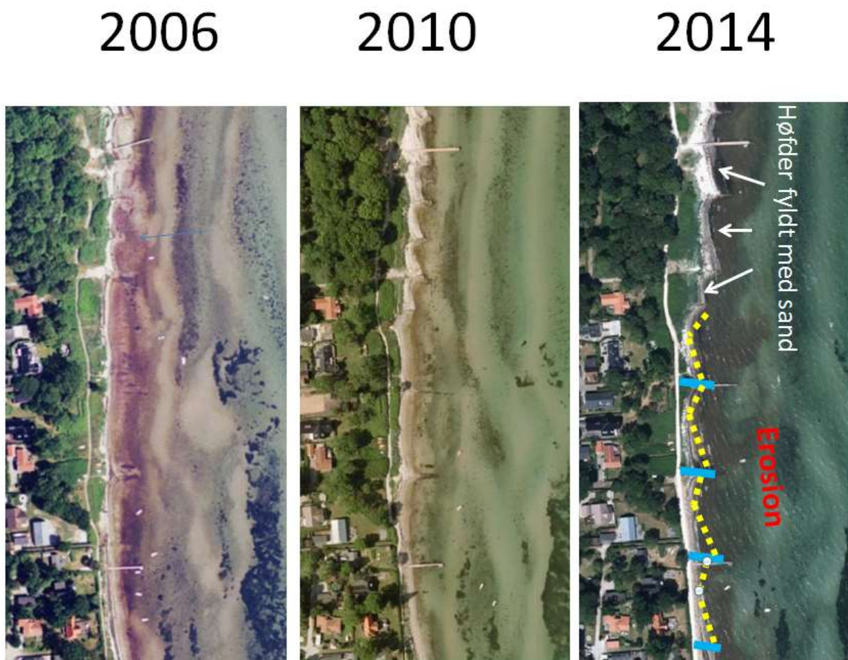
Figur 3-9 Udviklingen af hølferne opført af Hølferholderne fra 2006 til 2014. Hølferne har samlet sand og givet anledning til læsideerosion syd for den sidste hølfe. Der kan overvejes at forlænge de sydligste korte hølfer (vist med blå farve) og supplere med to ekstra hølfer med aftagende længde mod syd. Hølferne fyldes op med groft sand (gul punkteret linje) for at reducere læside erosionen (kilde NIRAS kort og Miljøportalen).
